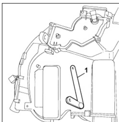
1. Gestänge des rechten Mischluftmotors entfernen.
