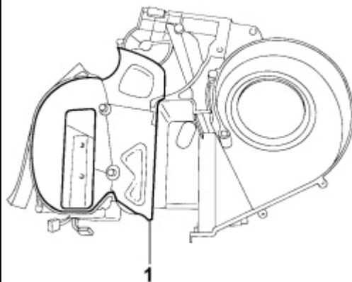
1. Elektrischen Stecker des linken Mischluftmotors trennen.
