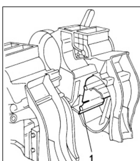
1. Rechte Mischluftklappen entfernen.
