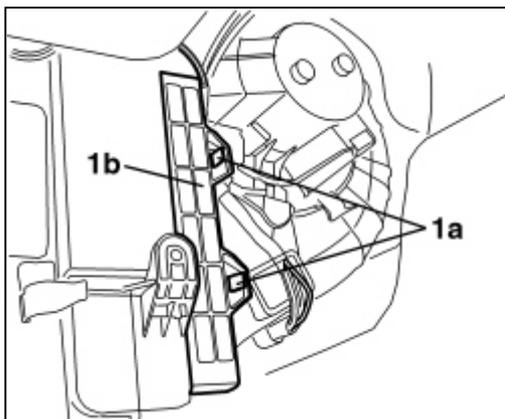
1. Halterungen (1a) lösen und den Deckel (1b) des Filtereinsatzes abnehmen.
