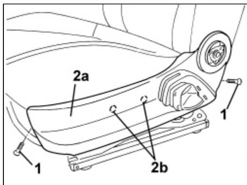
1. Die Befestigungsschrauben der äußeren Abdeckung lösen.
